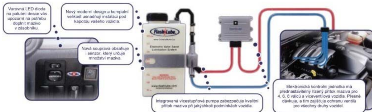
Schéma fungování soupravy Flashlube Electronic Valve Saver Kit
